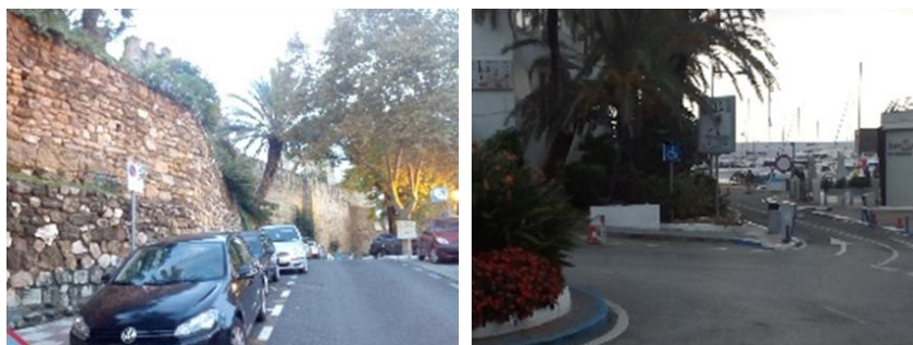
Foto: Plazas de aparcamiento reservadas para PMR, situadas en superficie con pendiente, sin zona de acercamiento y sin vado rebajado en sus inmediaciones
