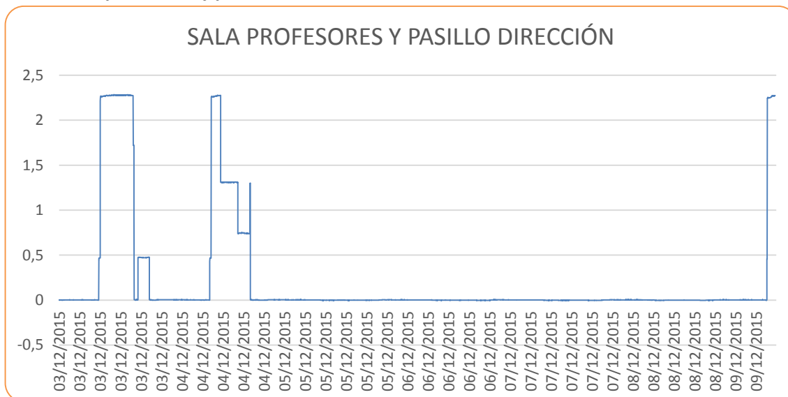
Gráfico 19 Registro de monofásico instalado en sala de profesores y pasillo dirección
