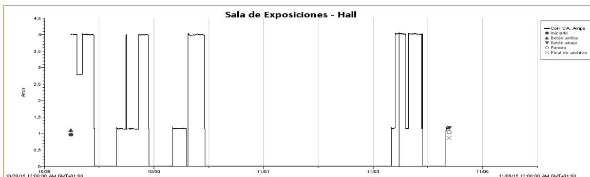
Gráfico 21 Registro de monofásico instalado en sala de exposiciones y hall.
