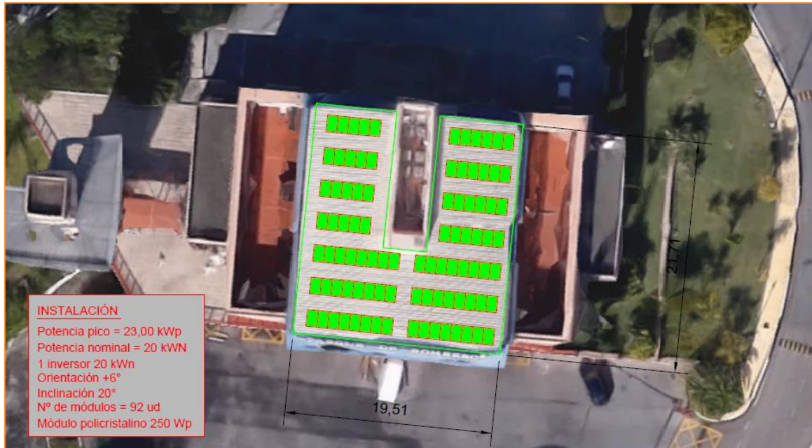
Imagen 5 Ubicación de los módulos en cubierta
