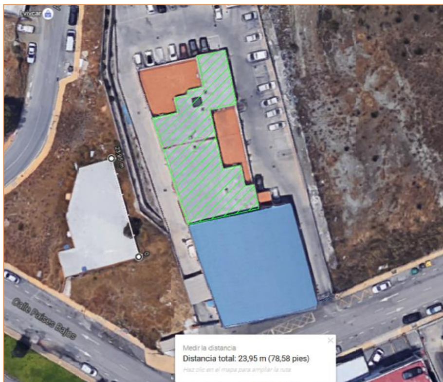
Imagen 4 Cubiertas consideradas para la implantación de los módulos fotovoltaicos
