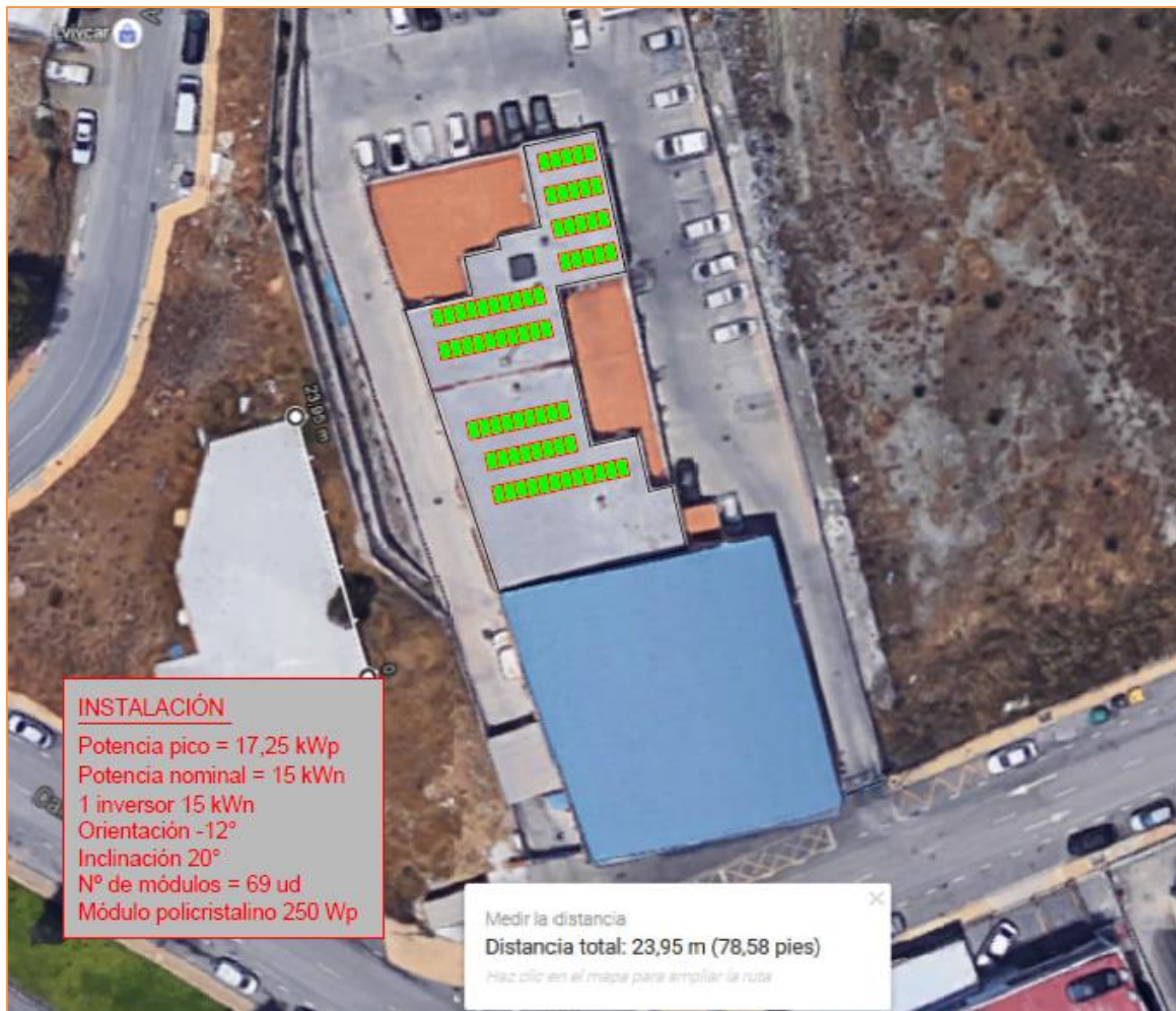
Imagen 5 Ubicación de los módulos en cubierta
