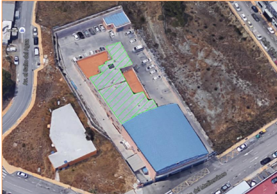
Imagen 3 Cubiertas consideradas para la implantación de los módulos fotovoltaicos
